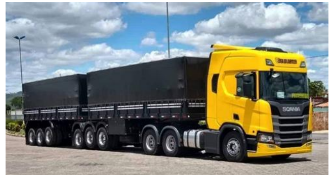
Figura 20 – RE - veículos comerciais com reboque, composto de uma unidade tratora simples, um semirreboque e um reboque
