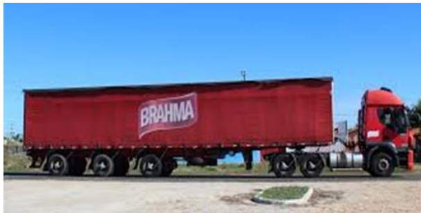
Figura 19 – SR - veículos comerciais articulados, compostos de uma unidade tratora simples (cavalo mecânico) e um semirreboque
