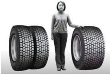
Figura 2 – Pneu comum de rodagem dupla e de rodagem singela com extralargo
