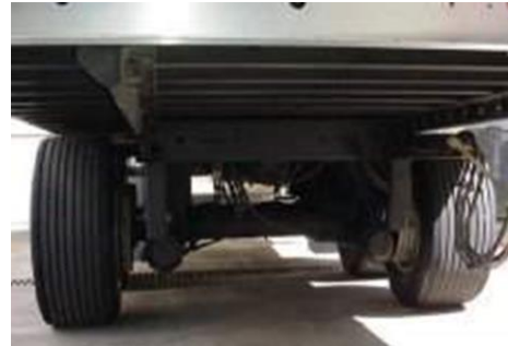
Figura 3 – Vista do eixo traseiro com rodagem singela com pneus extralargos
