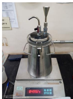
Figura 119 – Medição da massa do conjunto: kitasato + tapa + água
