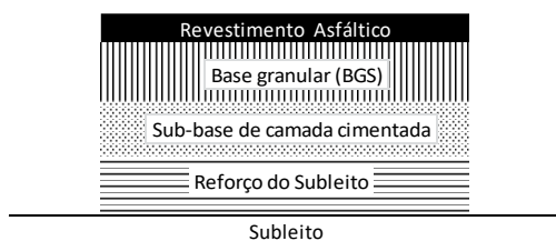
Figura 11 - Estrutura tipo de pavimento semirrígido invertido
