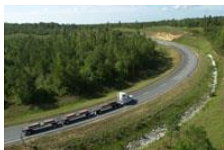
Figura 181 - Sistema de simulação do tráfego com veículos - http://www.ncat.us/facilities/test-track.html
