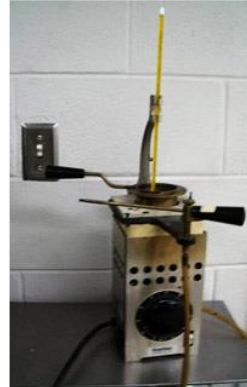
Figura 95- equipamento de ponto de fulgor, vaso aberto de Cleveland
