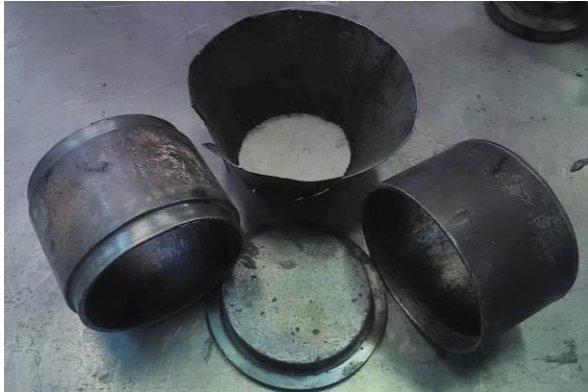
Figura 126 - Detalhe do molde, base e colarinho - Marshall
