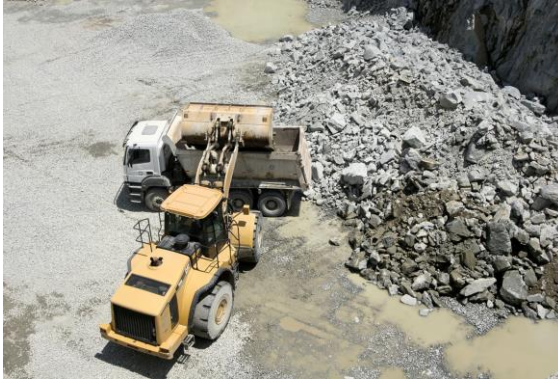
Figura 18- Caminhões fora de estrada utilizados no transporte dos blocos de rochas para o britado de mandíbula
