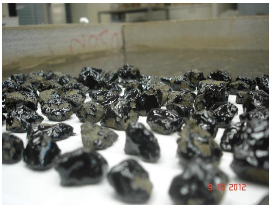
Figura 91 - Adesividade ligante asfáltico/agregado não satisfatório
