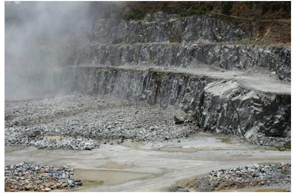
Figura 16 - Bancada após o fogo
