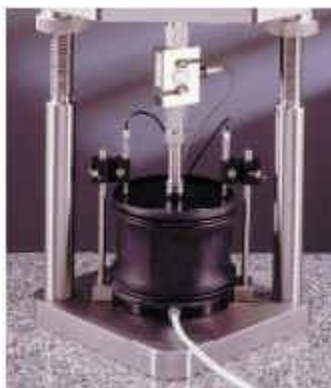
Figura 165 - Ensaio de creep axial sem confinamento com emprego de estrutura para adensamento de solos (SÁ, 1996)
