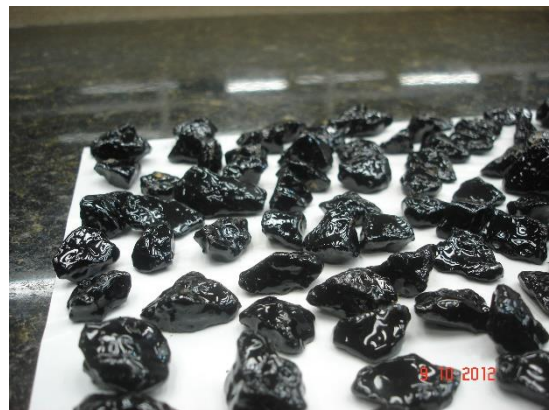
Figura 92 - Adesividade ligante asfáltico/agregado satisfatório
