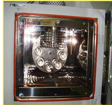
Figura 97 - Frasco utilizado na estufa RTFOT
