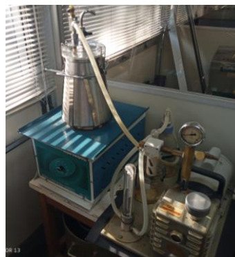
Figura 114 - Montagem do conjunto: mesa oscilante, bomba de vácuo e kitasato
