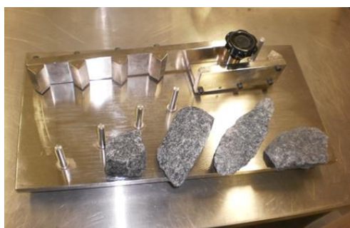
Figura 37 - Calibre para determinação das relações entre as dimensões da amostra de agregado
