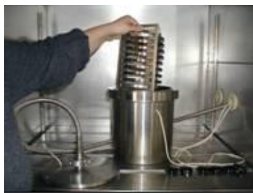
Figura 99 - Acondicionamento das provas no vaso de pressão
