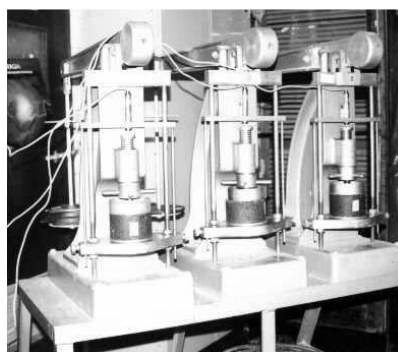
Figura 165 - Ensaio de creep axial sem confinamento com emprego de estrutura para adensamento de solos (SÁ, 1996)
