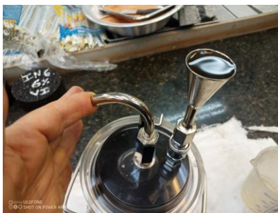
Figura 116 - Completando o volume com água após a fixação da tampa
