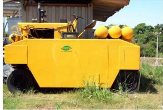
Os rolos de pneus estáticos (Figura 43) são muito utilizados para selagem da camada de forma a regularizar o acabamento da camada compactada. Nesse processo a parcela da camada mais densificada é a superior que recebe diretamente a ação da carga dos pneus
