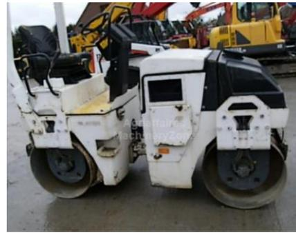
Os rolos metálicos lisos de três rodas (Figura 38) são tipos de equipamentos que compactam o solo por compressão ou pressão estática, tem duas traseiras e uma dianteira sendo essa a que possui maior massa. No mesmo processo de densificação do solo têm-se os rolos metálicos lisos em tandem (Figura 39), equipamentos com dois cilindros um dianteiro e outro traseiro de mesma largura, comumente o dianteiro de maior diâmetro e é denominado de pressão enquanto o traseiro é chamado de direcional.
