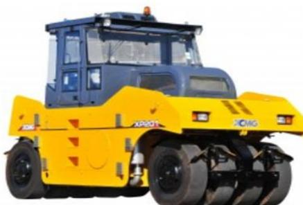
Na Figura 48 é apresentado o rolo pneumático, esse equipamento apresenta bom desempenho para solos siltosos e areias finas, da mesma forma que ocorre para o rolo pé-de-carneiro, a compactação se dá de baixo para cima, pois com o recurso de se regular a pressão de inflagem dos pneumáticos altera-se a área de contato, dessa forma, pode-se atingir camadas inferiores devido a elevada pressão que se dispõe com esse tipo de equipamento.
