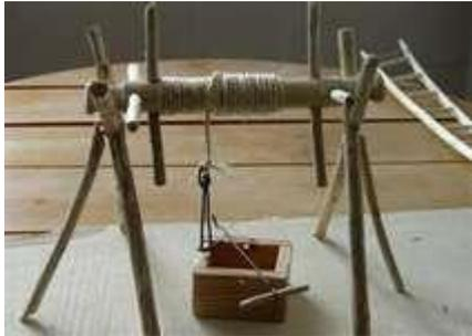
Figura 23 - Sarilho instalado em poço
