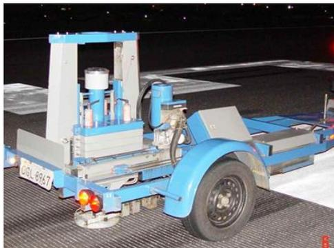
Figura 116 - Detalhe da placa e dos geofones
