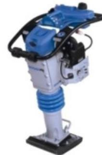
As placas de impacto (Figura 44) compactam o solo com efeito de vibração que tem origem em um excêntrico acoplado a um motor à gasolina que transfere vibração para uma placa metálica que tem contato direto com o solo. Da mesma forma, um motor à gasolina proporciona uma oscilação (vibração), para o soquete de impacto, conhecido como sapo mecânico (Figura 45). Nesse último, ocorrem menor frequência e maior amplitude comparativamente à placa de impacto.
