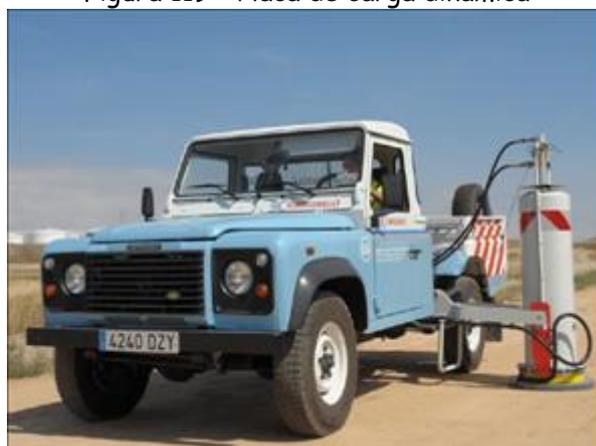
Para determinar o módulo dinâmico, depois de localizar o ponto de auscultação, aplicar três sucessivas cargas dinâmicas, intensidade e duração definida em queda livre de uma massa sobre o prato, em seguida, realizar a medição direta dos seguintes parâmetros: carga e deformação.
