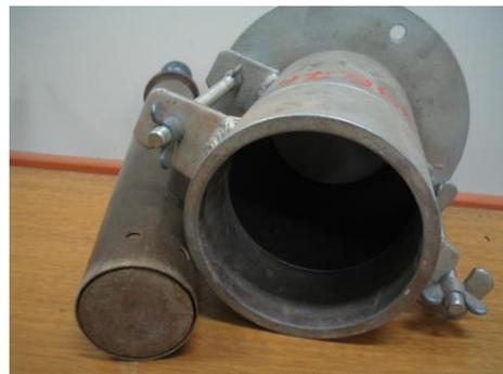
Figura 103 - Cilindro de CBR - 2000 cm<sup>3</sup>
