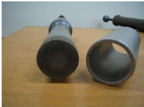
Figura 102 - Suporte de moldagem equipamento de Iowa
