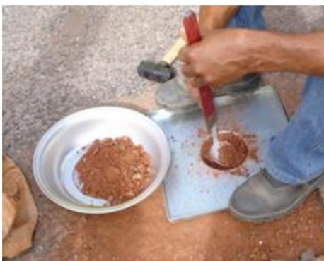
Figura 127 - Espessura da camada e peso de solo coletada
