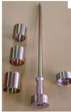
A inconveniência desse procedimento é que quando se crava o molde cilíndrico na camada o molde acaba por compactar a porção de solo dentro do molde. Outro inconveniente é que ocorrem distorções no molde que propiciam a alteração de seu volume.
