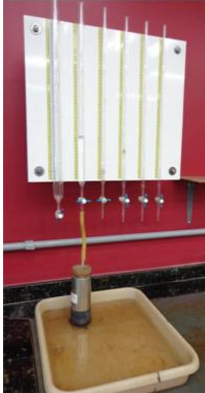
Os corpos de prova devem ser compactados segundo procedimento do ensaio M-Proctor eventualmente submetidos ao ensaio de infiltrabilidade. Neste caso acima do corpo de prova comporta já pedra porosa e sobrecarga.
