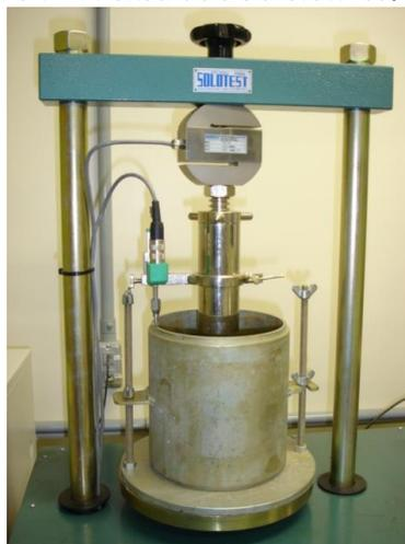
Acionar a prensa (manual ou elétrica) de forma a penetrar a amostra com o pistão de penetração a uma velocidade de 1,27mm/min. A prensa elétrica (**Figura 64**) é munida de uma célula de carga que possibilita através de uma leitora indicar a carga correspondente às penetrações: 0,63, 1,27,
